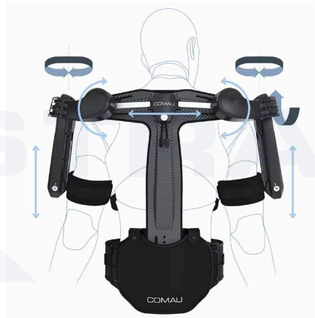
Grâce à une chaîne de degrés de liberté passifs, l'axe de rotation flexion-extension de l'épaule humaine est aligné sur celui de MATE-XT.
